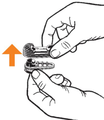
*Kühleinheitdeckel vom Kühleinheitboden abziehen*
